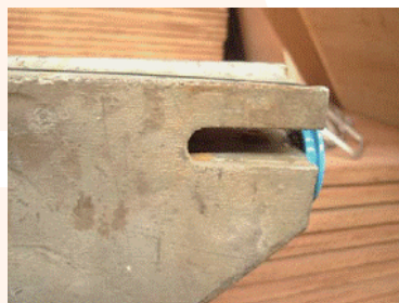
挂衣梁（衣架巴）测试后状态-左侧/右侧，槽口和焊缝处并没有出现断裂或裂纹。
