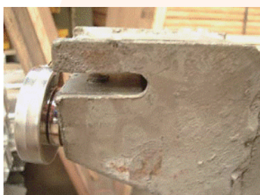
挂衣梁（衣架巴）测试后状态-左侧/右侧，槽口和焊缝处并没有出现断裂或裂纹。
